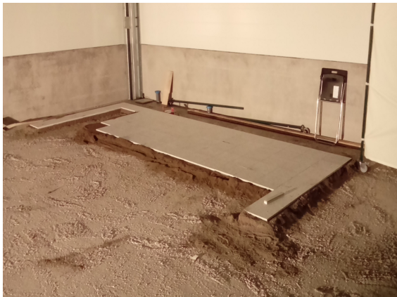
Figur 5: Exempel på lagda plattor med maskinen. Vi la 10-20m 2 yta vid varje fälttest. Plattorna bröts upp efteråt och fästytan mellan plattor och bruk analyserades.
